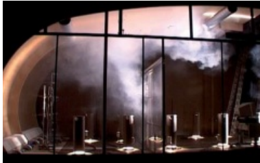
Ensayos de flujo de aire: Maqueta desarrollada en los laboratorios de investigación y desarrollo del GRUPO TROX
