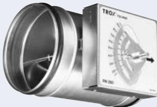
Os controladores de fluxo de volume de ar Trox tipo R são controladores alimentados por sistema mecânico para sistemas de volume constante. Os controladores de taxa de fluxo de volume não requerem uma fonte de alimentação externa. Uma lâmina de controle de movimento livre é posicionada por forças aerodinâmicas de modo que um fluxo de volume predefinido possa ser mantido constante ao longo de toda a faixa de pressão diferencial
